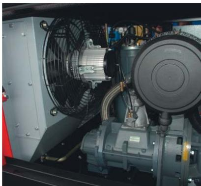
В модельном ряду компрессоров с электрическим приводом представлены модели с рабочим давлением от 7 до 13 бар и производительностью от 1,8 м³/мин до 26,6 м³/мин. Модели CPS 350E, 400E-10, 450E — одноступенчатые винтовые маслозаполненные компрессоры с прямым приводом от электрического мотора.
