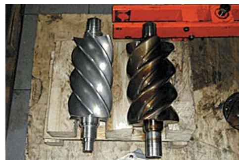
На рис. справа винт после использования НЕ оригинального масла
